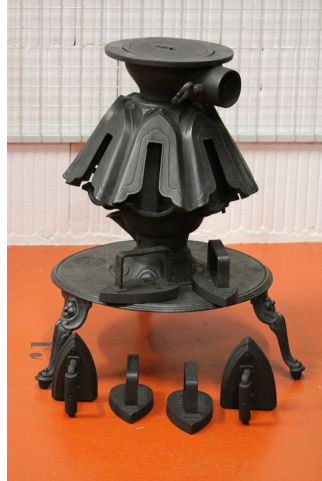
Repassouse n° 8 Bis à enveloppes équipée de 6 fers à repasser
