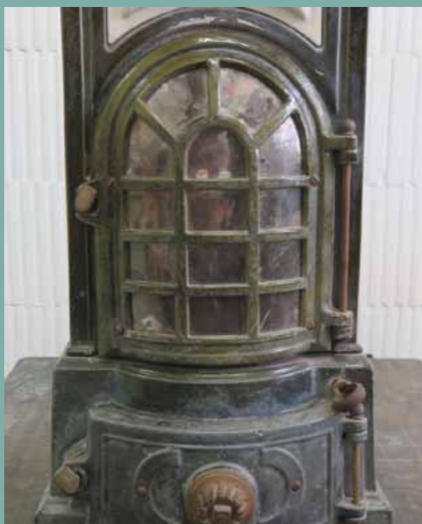
Calorifère hygiénique n° 2188D (inv. n° 2000-2-12, avant et après traitement en 2020 : les parties métalliques oxydées sont nettoyées et stabilisées, l'émail vert a de nouveau de l'éclat et les plaques de mica qui ferment le foyer retrouvent de la transparence.
