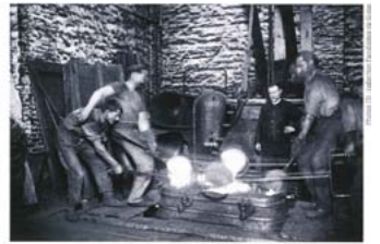
Dans l'usine du familistère de Guise, en 1899, quatre mouleurs versent de la fonte de fer liquide pour fabriquer une baignoire estampilée «Godin».
